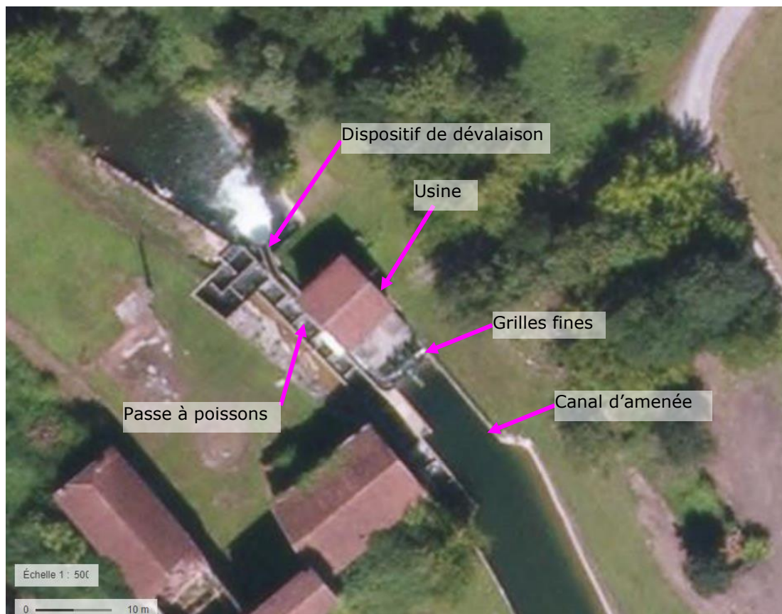
Figure 4: Zoom sur usine existante – 1/500 ème
